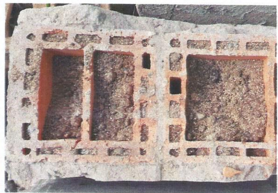
Foto 2: Blocos retirados da parede ensaiada exemplificando o preenchimento total dos furos com vermiculita expandida
